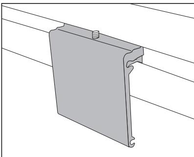
2. Localisez la position souhaitée le long d'une voie ferrée SureMount. Placez le support d'accessoire dans la rainure du rail de façon à ce que la lèvre saisisse le bord supérieur de la glissière.
