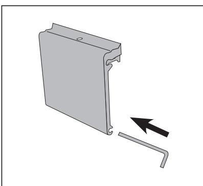
3. Utilisez la clé hexagonale pour serrer la vis de réglage, en dépliant le support de charnière dans le bord inférieur de la rainure jusqu'à ce qu'il soit bien serré. Le support d'accessoire doit maintenant être immobile avec les deux bords fermement insérés dans la voie ferrée.
