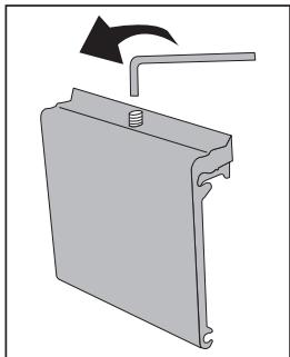
1. Retirez la clé hexagonale du manchon de la clé hexagonale au bas du support d'accessoires. Desserrez la vis de réglage dans le support d'accessoires pour permettre au support de charnière une gamme complète de mouvement.
