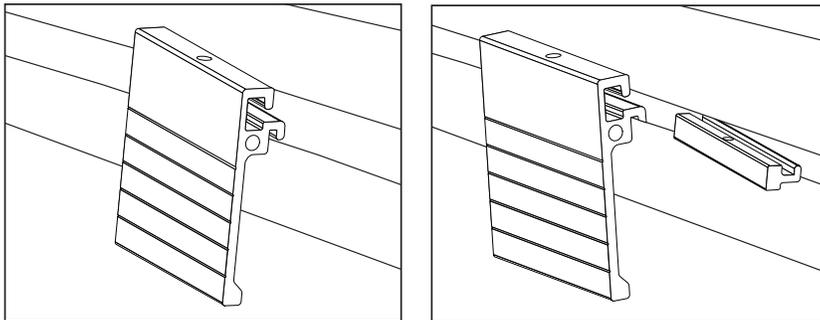
2. Localisez la position souhaitée le long de la voie ferrée. Placez le support d'accessoire dans la rainure du rail de sorte que la lèvre s'accroche au bord supérieur du rail.
