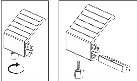
1. Retirez la vis à molette de la fixation d'accessoire, ce qui permet de retirer l'insert coulissant et de permettre au support de charnière d'avoir toute l'amplitude de mouvement lors de l'installation.
