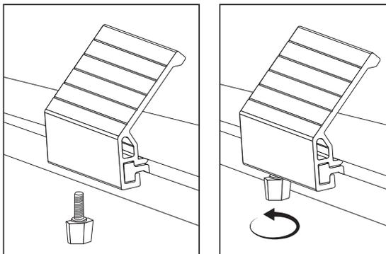
4. Centrez l'insert coulissant et serrez la vis de réglage à l'aide de la vis de réglage en étendant le support de charnière vers le bas dans le bord inférieur de la rainure jusqu'à ce qu'il soit bien ajusté. L'accessoire se monte sur la voie ferrée.
