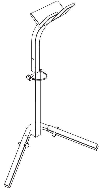
La hauteur du support peut être ajustée en enlevant la broche de levage et le support de stockage. Toujours fixer solidement la broche par la poste centrale et le support de stockage après les ajustements de hauteur.
