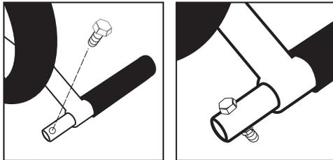
Installez des barres d'ascenseur en glissant dans le tube de cadre à l'aide de deux 1/4"x 1-3/4" vis et deux 1/4" écrous frein.\*
