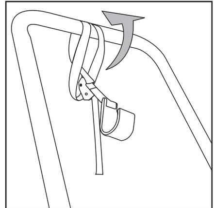
Installez la sangle de levage en enveloppant la fin torsadée cousu de la sangle sur la poignée et laisser tomber la boucle de la sangle à travers la boucle avec le crochet vers l'avant.
